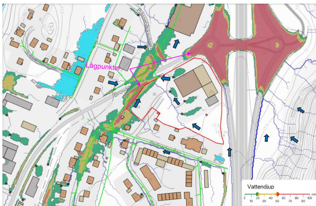
Figur 7 Rinnvägar och lågpunkter inom planområdet i befintlig situation. Blå linjer visar huvudsakliga flödesvägar, blå pilar anger flödesriktning och grön-, gul- och rödfärgade ytor illustrerar potentiella vattenansamlingar vid olika vattendjup. Norconsult, 2026.
