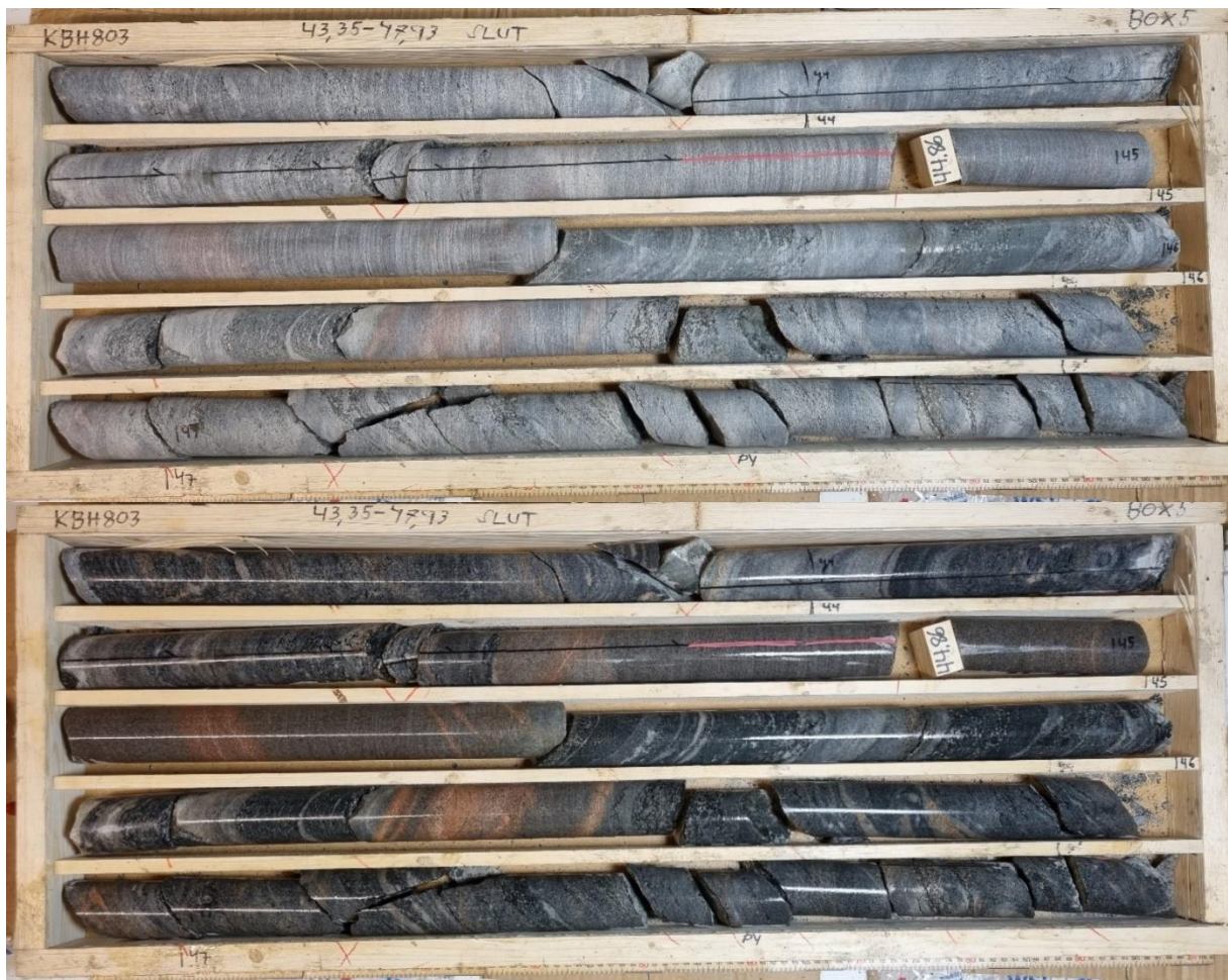
Figur 13. KBH803, låda 5. 43,35–47,93 m. Torr/fuktad.
