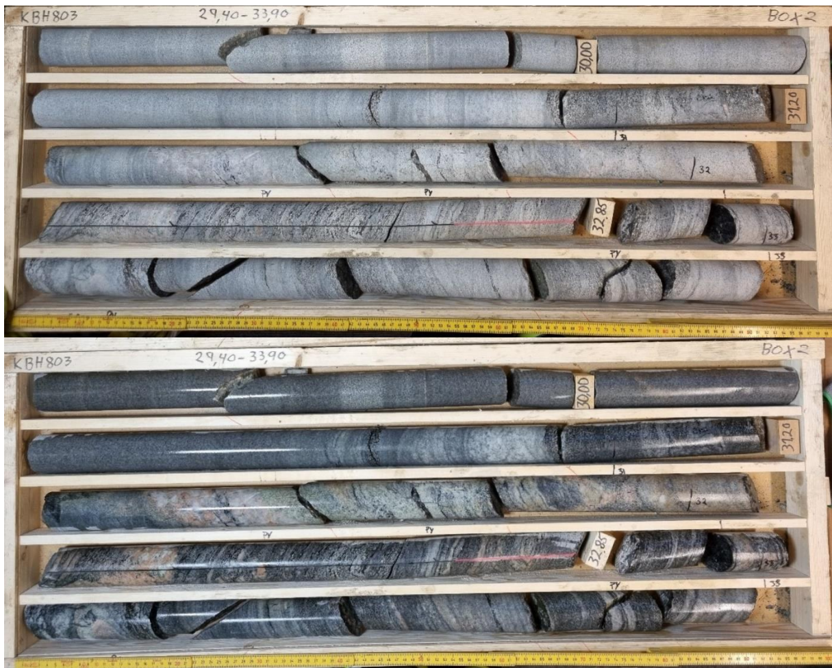
Figur 10. KBH803, låda 2. 29,40–33,90 m. Torr/fuktad.
