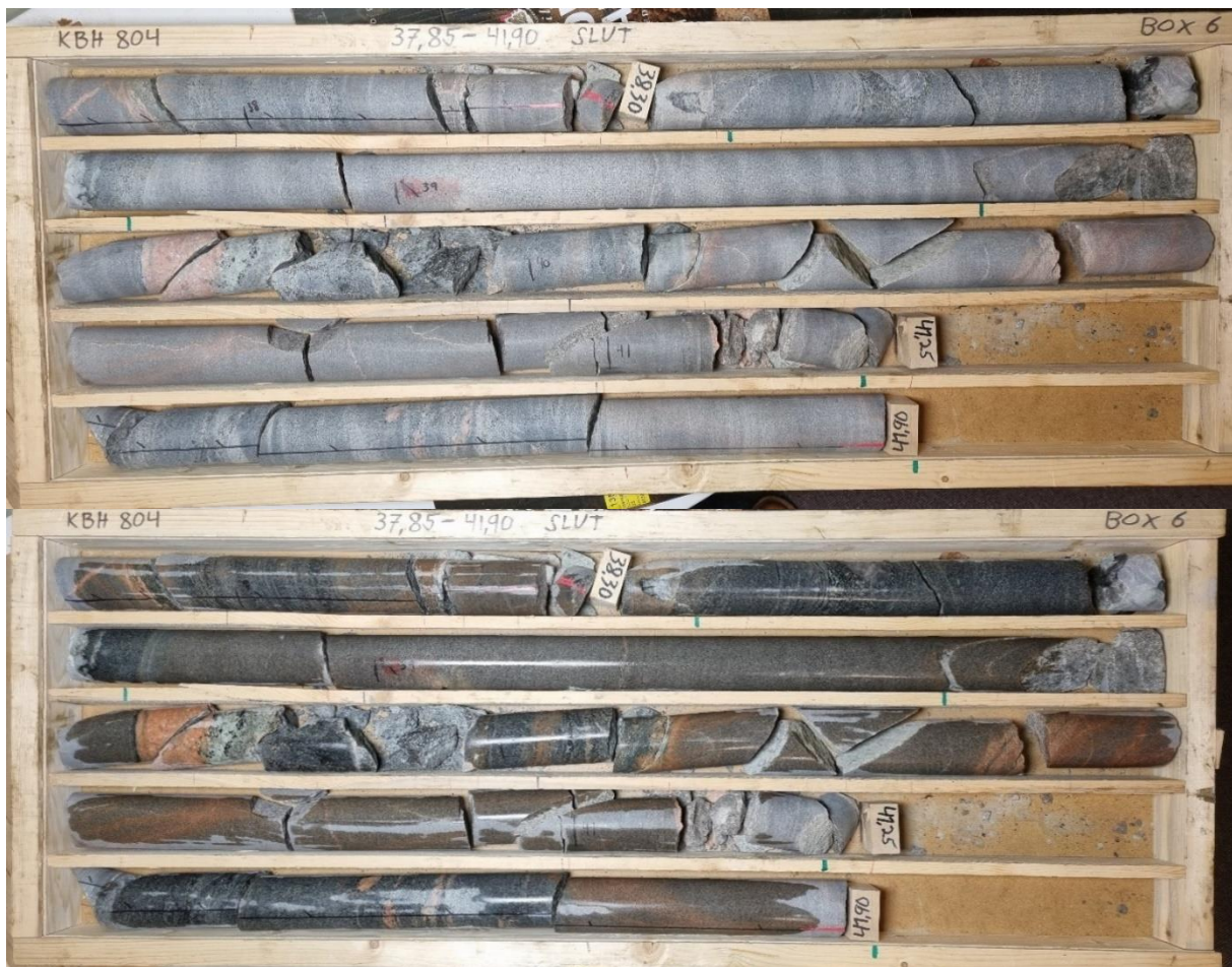
Figur 19. KBH804, låda 6. 37,75–41,90 m. Torr/fuktad.
