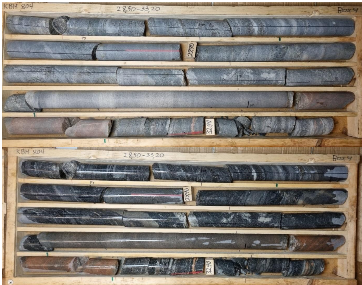
Figur 17. KBH804, låda 4. 28,50–33,20 m. Torr/fuktad.
