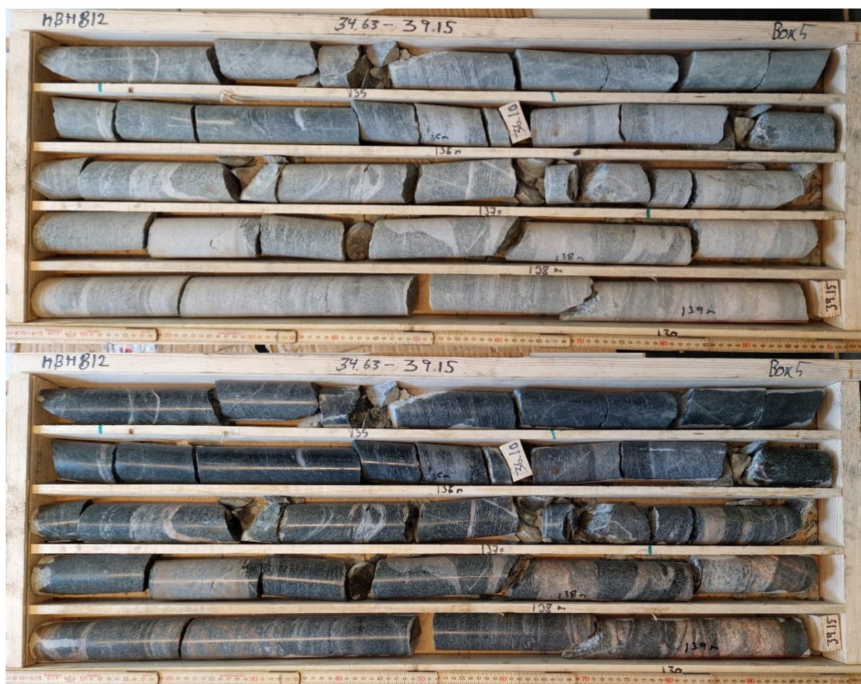
Figur 47. KBH812, låda 5. 34,63–39,15 m. Torr/fuktad.
