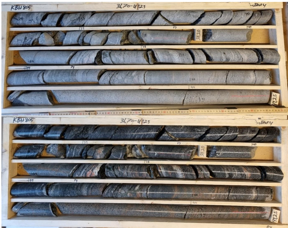
Figur 23. KBH805, låda 4. 36,70–41,25 m. Torr/fuktad.
