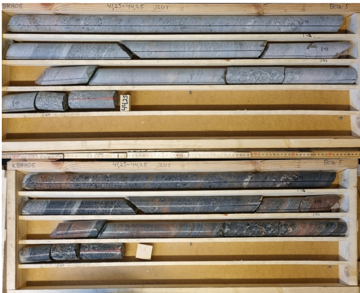
Figur 24. KBH805, låda 5. 41,25–44,25 m. Torr/fuktad.
