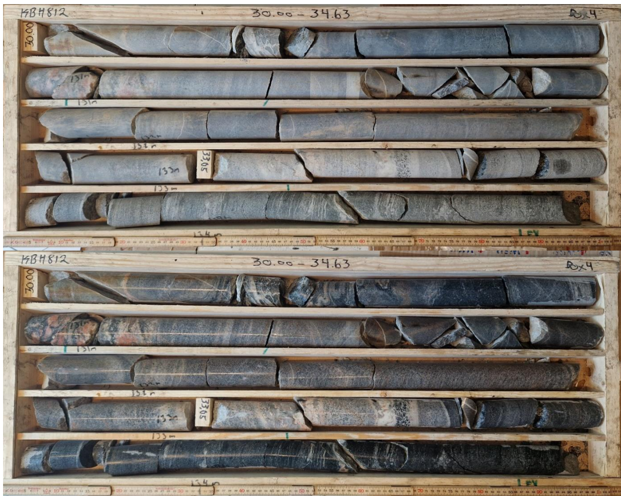
Figur 46. KBH812, låda 4. 30,00–34,63 m. Torr/fuktad.
