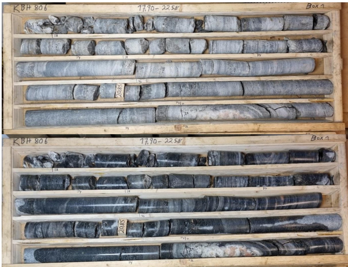
Figur 25. KBH806, låda 1. 17,90–22,58 m. Torr/fuktad.
