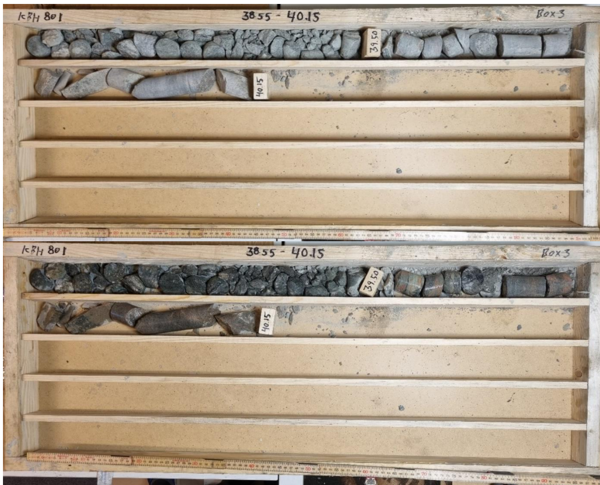
Figur 3. KBH801, låda 3. 38,55–40,15 m. Torr/fuktad.
