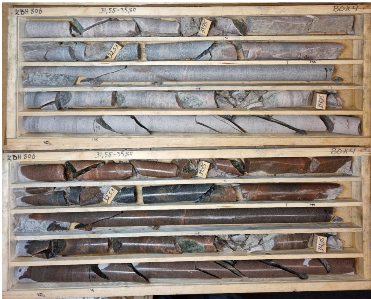
Figur 28. KBH806, låda 4. 31,55–35,80 m. Torr/fuktad.
