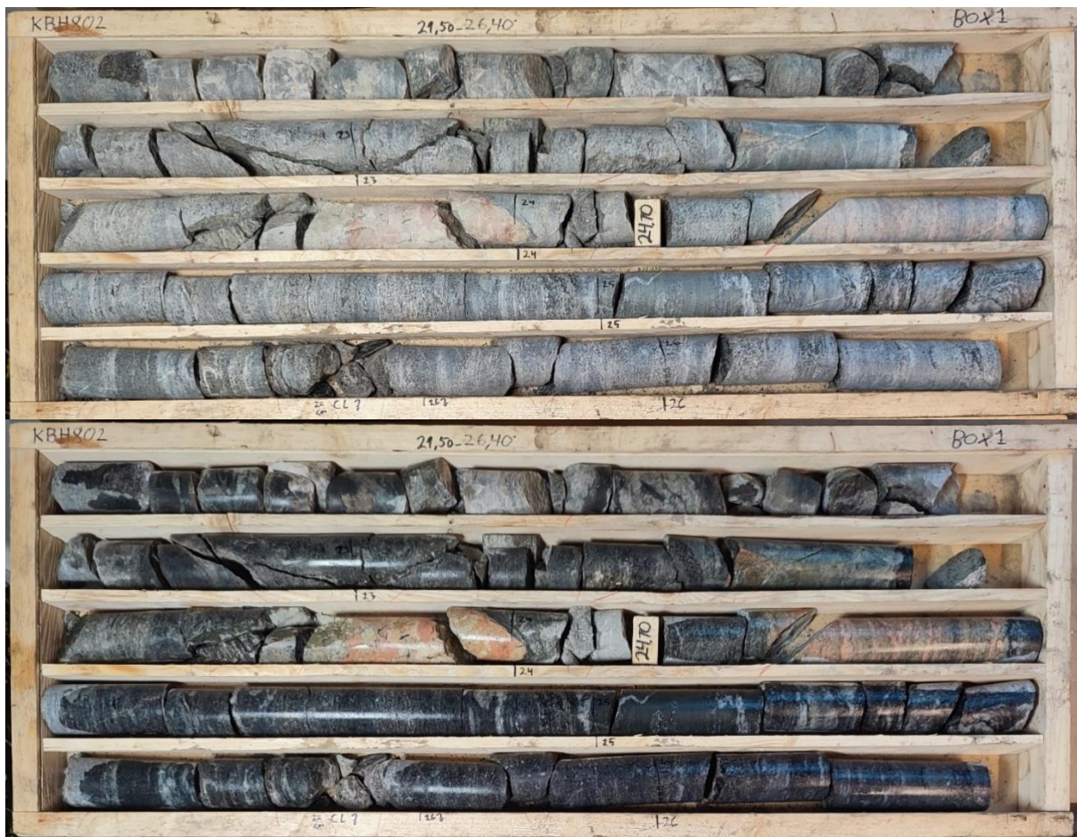
Figur 4. KBH802, låda 1. 29,50–26,40 m. Torr/fuktad.
