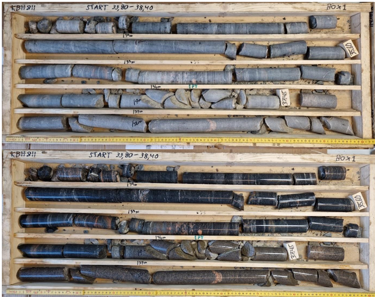
Figur 40. KBH811, låda 1. 33,80–38,40 m. Torr/fuktad.
