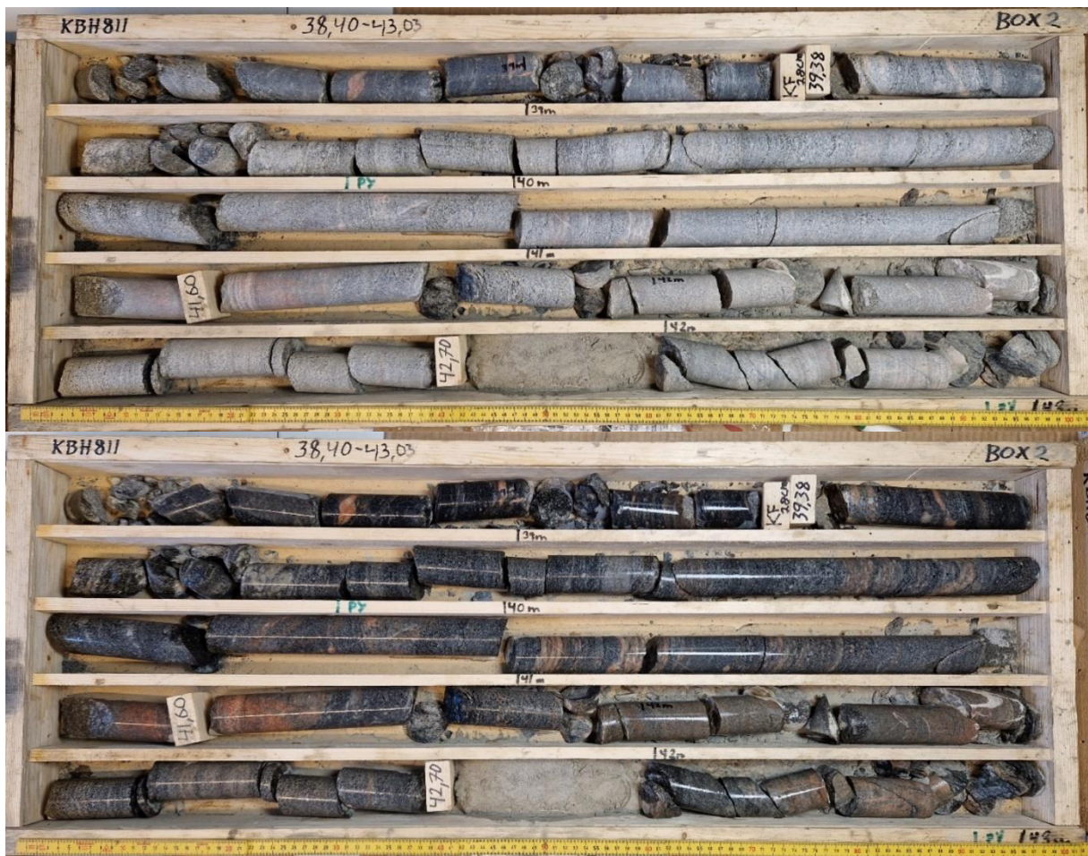
Figur 41. KBH811, låda 2. 38,40–43,03 m. Torr/fuktad.
