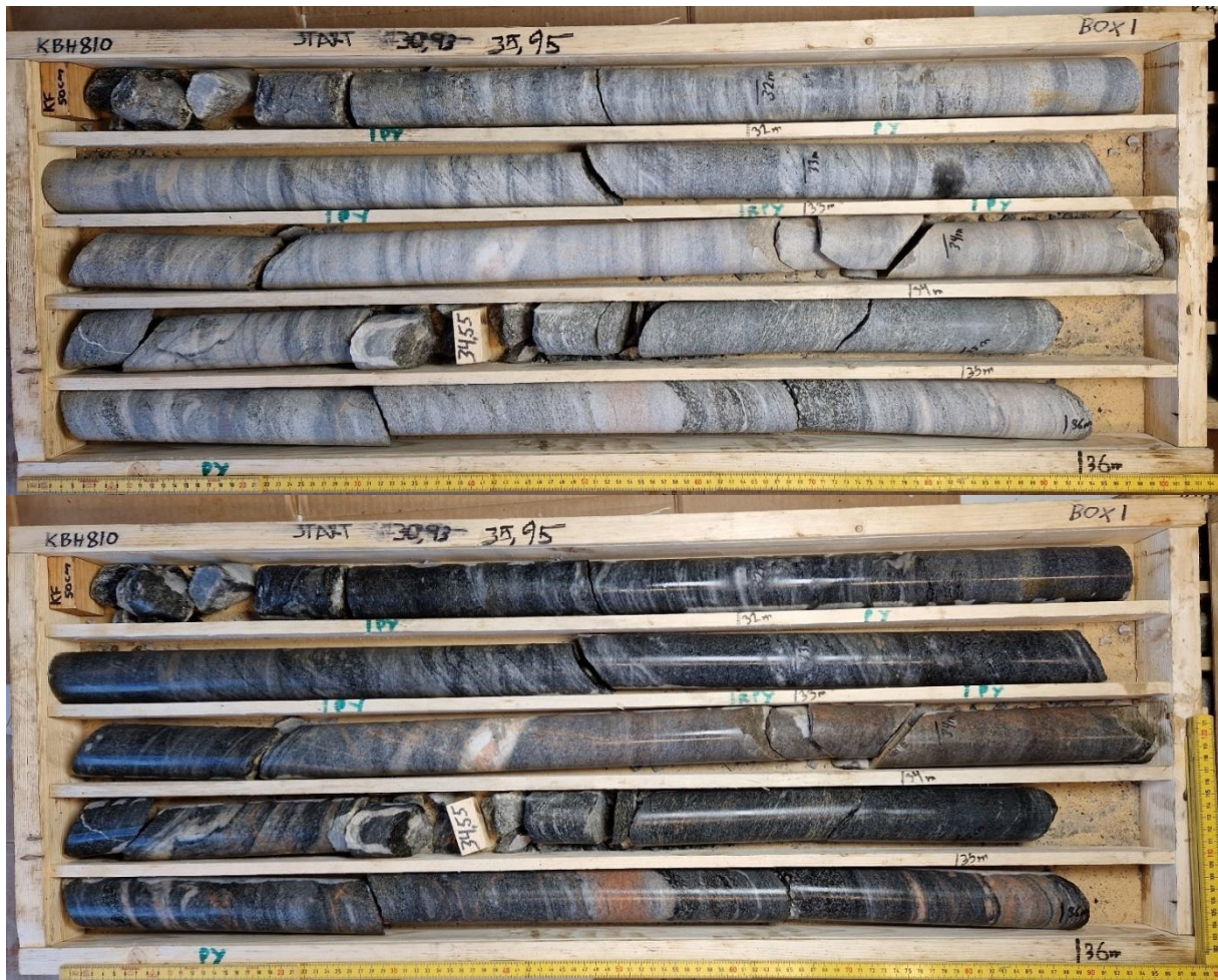
Figur 38. KBH810, låda 1. 30,93–35,95 m. Torr/fuktad.
