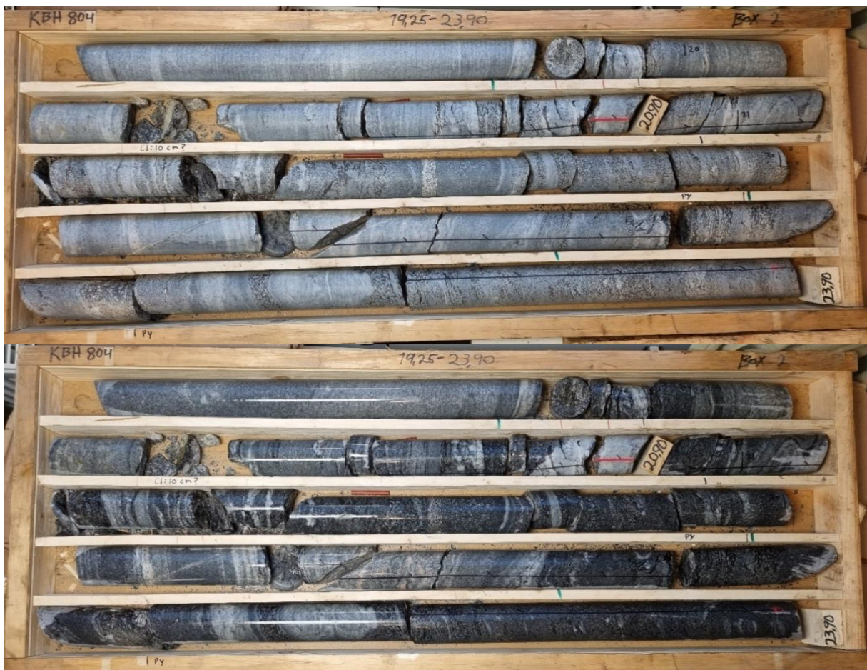
Figur 15. KBH804, låda 2. 19,25–23,90 m. Torr/fuktad.
