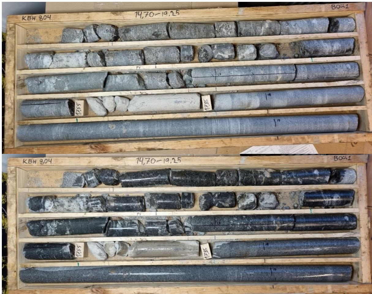
Figur 14. KBH804, låda 1. 14,70–19,25 m. Torr/fuktad.
