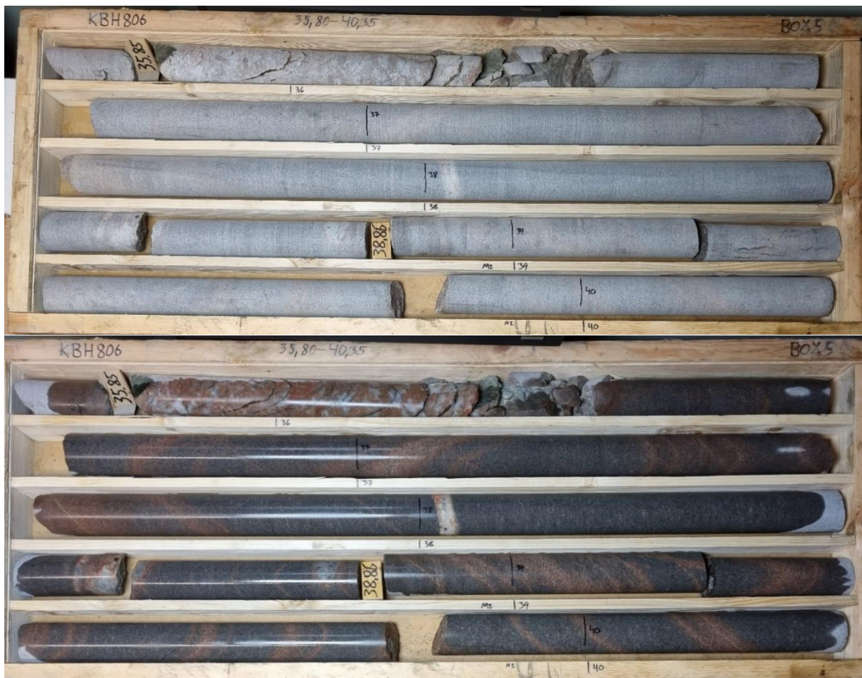
Figur 29. KBH806, låda 5. 35,80–40,35 m. Torr/fuktad.
