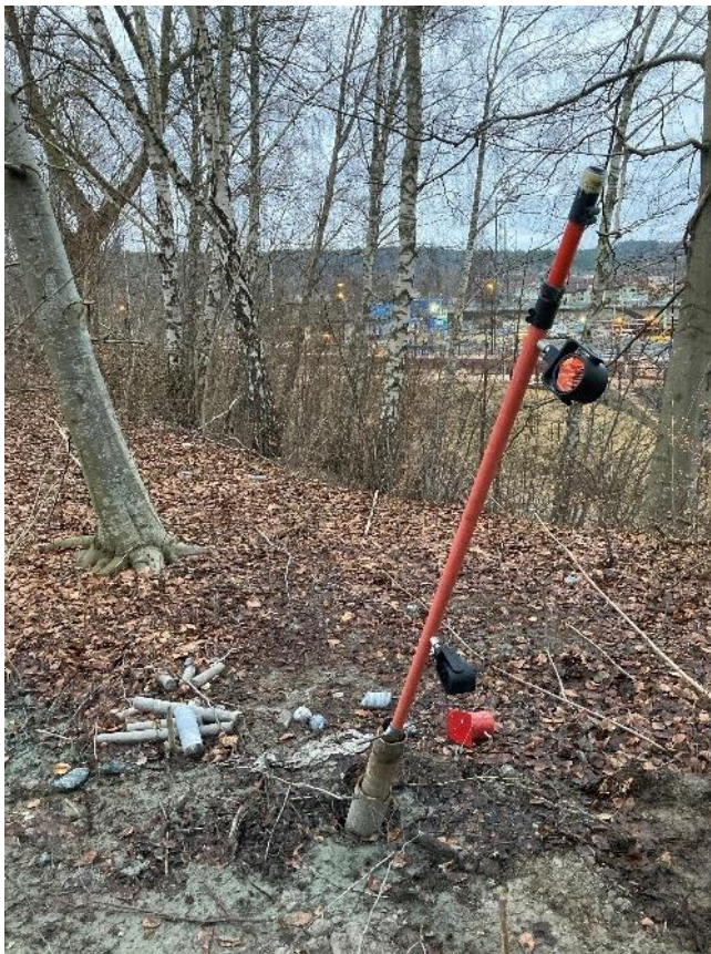
Figur 2. Mätpinne med prismor för inmätning av riktning.
