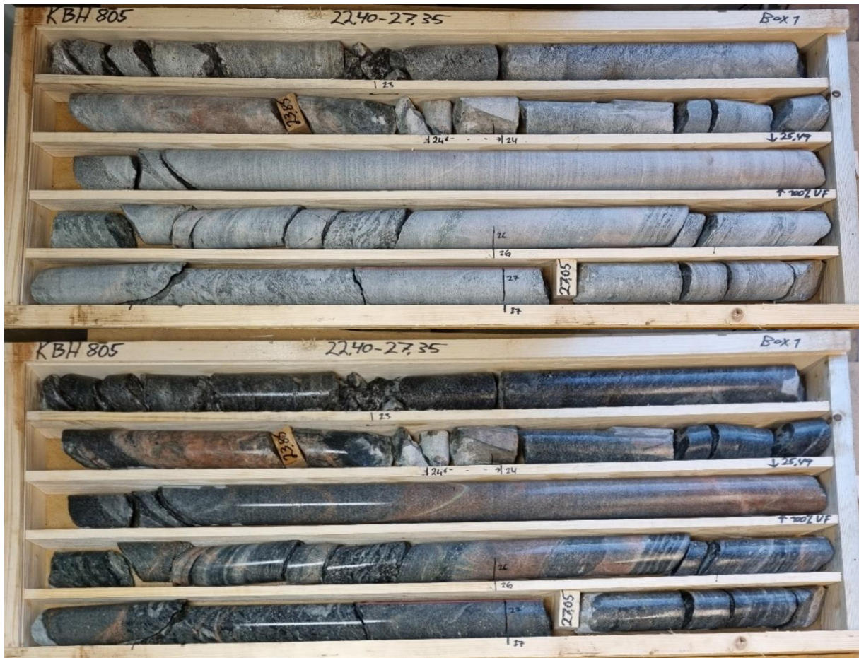
Figur 20. KBH805, låda 1. 22,40–27,35 m. Torr/fuktad.
