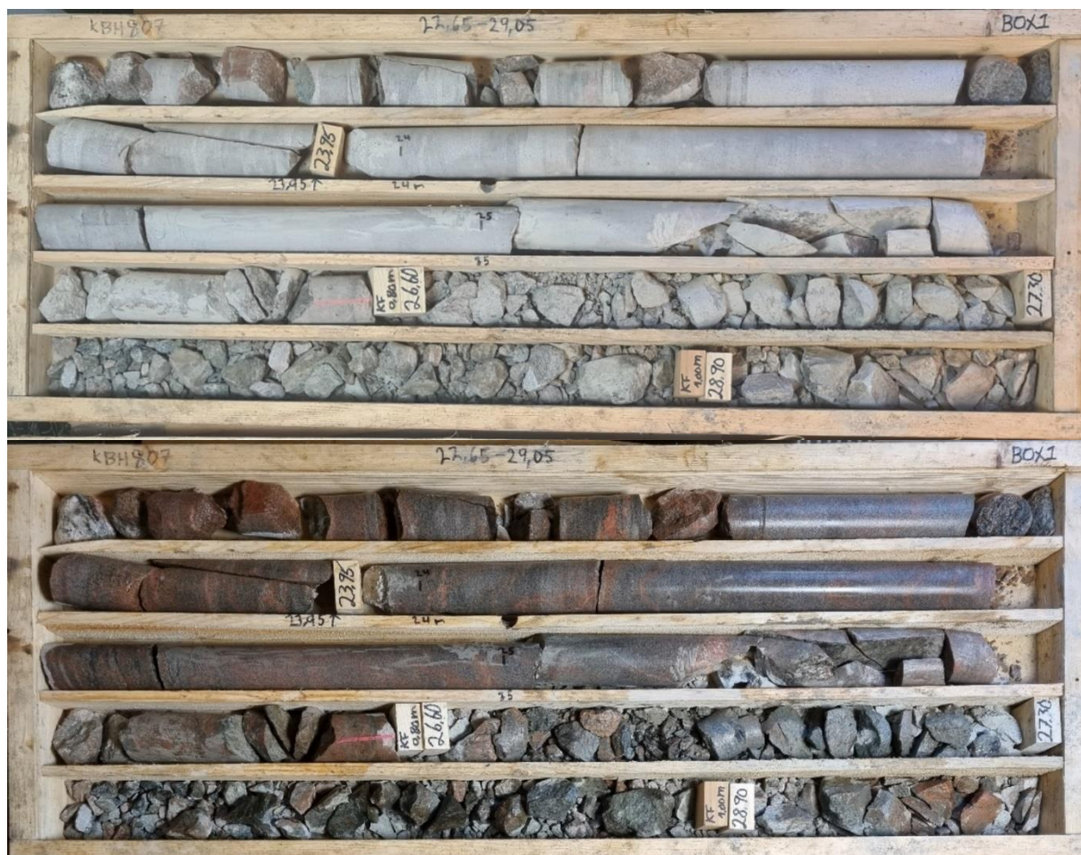
Figur 32. KBH807, låda 1. 22,65–29,05 m. Torr/fuktad.
