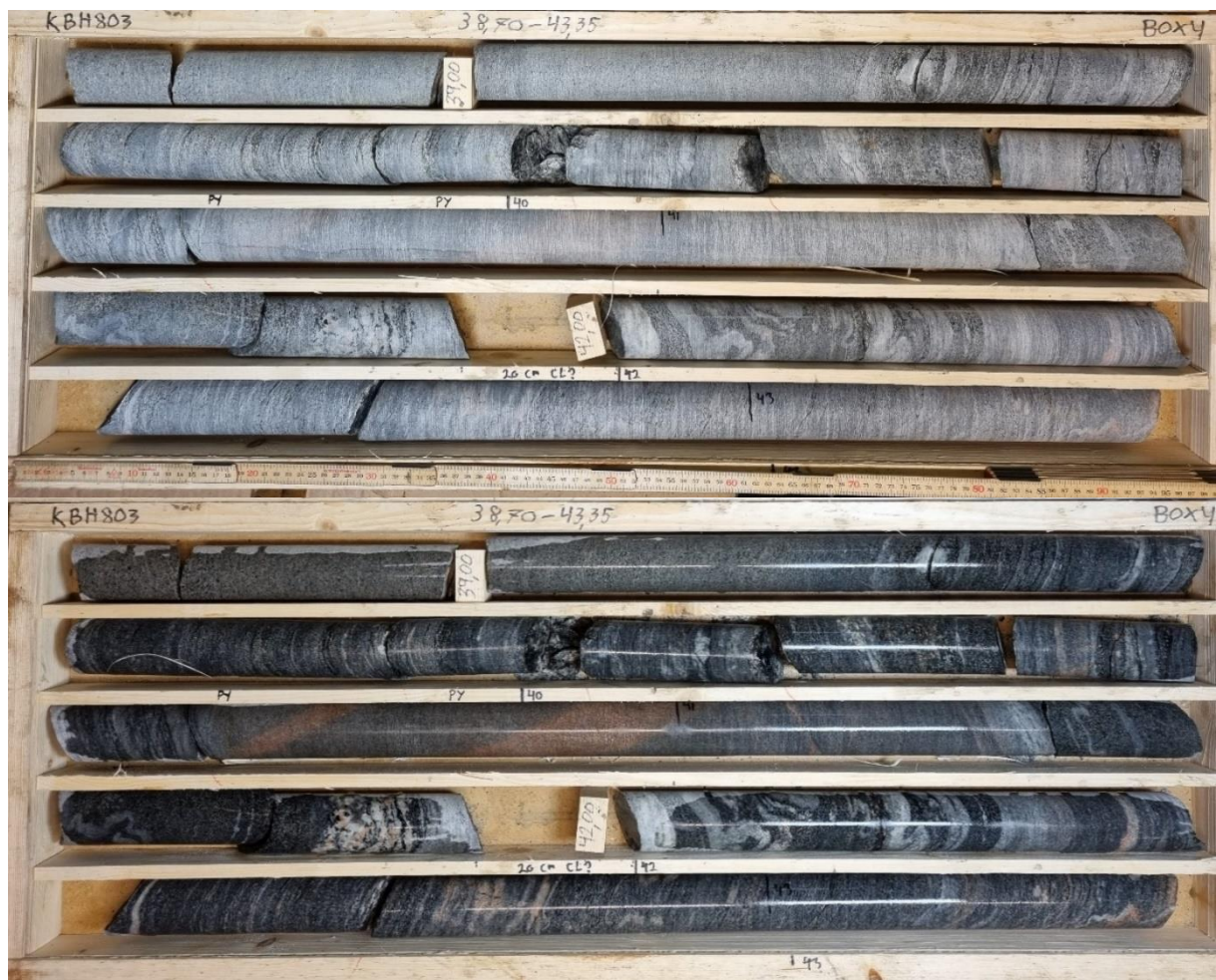
Figur 12. KBH803, låda 4. 38,90–43,35 m. Torr/fuktad.
