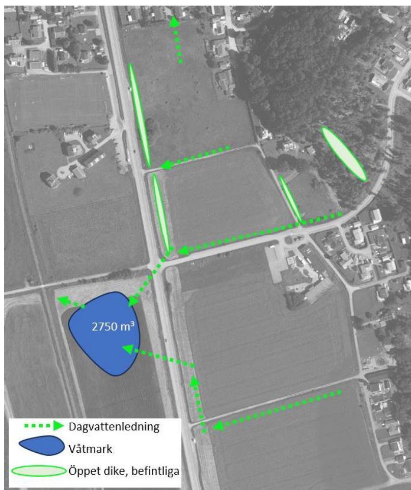
Föreslagen dagvattenlösning (Illustration Ramboll med underlag från Norconsult, 2025).
