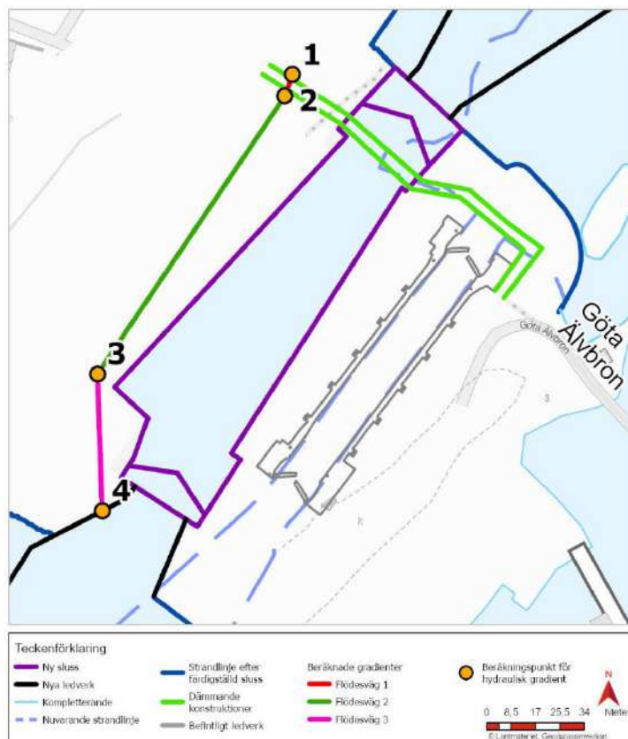
Figur 35. Antagna flödesvägar i plan för beräkning av hydrauliska gradienter. Notera att flödesväg 1 (rött streck) avser en strömning under den dämmande konstruktionen, se även figur 36.
